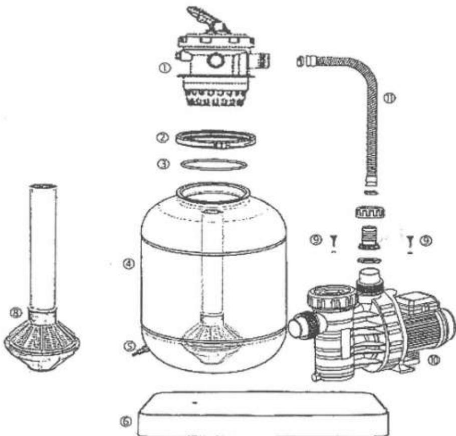
Postavite filtrske posode (4) na pripadajočo podlogo (6). Postavite filtrske črpalko(10) postavite na črno podlogo tako, da se bo bo povezovalna cev (11) lahko montirala na ventil (1). privijte črpalko s vijaki, ki so priloženi(9). nato sestavite 6 potni ventil (1) in ga priklopite povezovalni del na priklop z oznako PUMP. pri črpalki se porabi zgornji del cevi za priklop.
